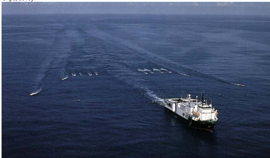
Slika 1.17 Snimanje 3D seizmike s 4 linije streamera i više zračnih pušaka (izvor: Dragoset, 2005.)
