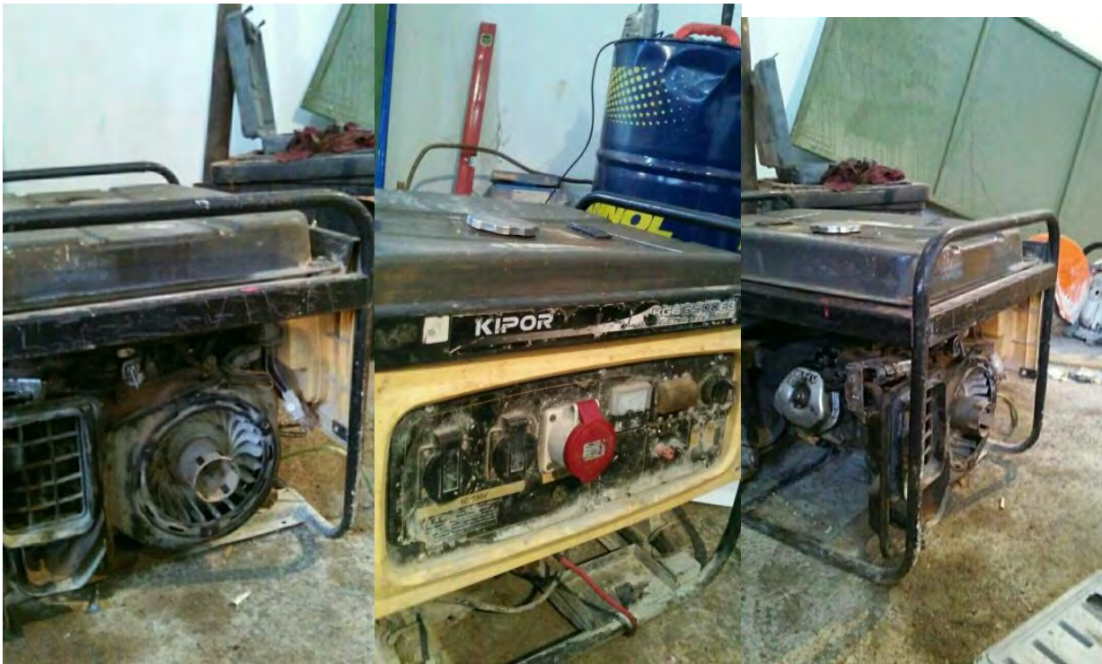
sl.3.1.4. Agregati -alternativni izvor energije za napajanje mlina čekićara
