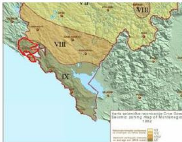
Slika 2.5: Karte očekivanih maksimalnih intenziteta zemljotresa sa konturom Opštine Herceg Novi ("Privremena seizmološka karta SFRJ (dio za Crnu Goru)", 1987.god.);
