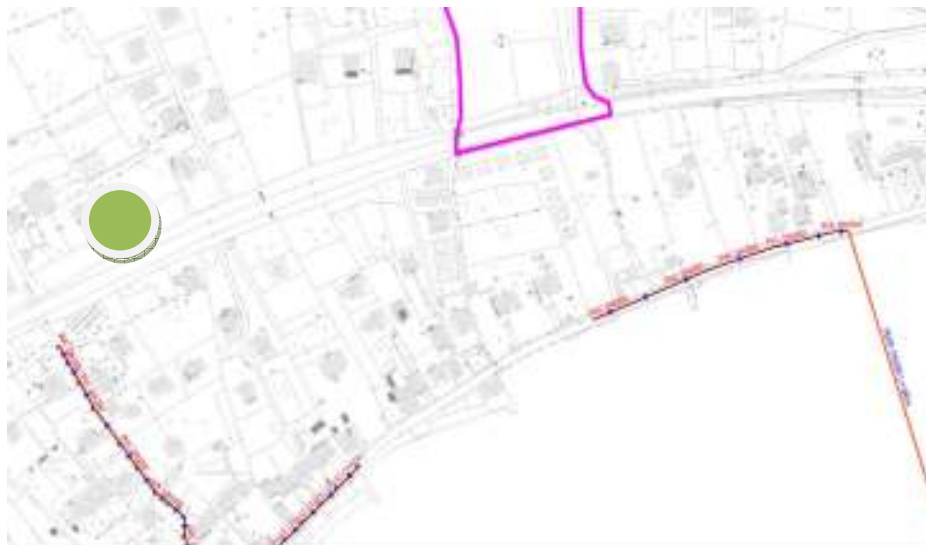
Slika 5.8. Izvod iz plana kanalizacije, sa označenom mikrolokacijom
