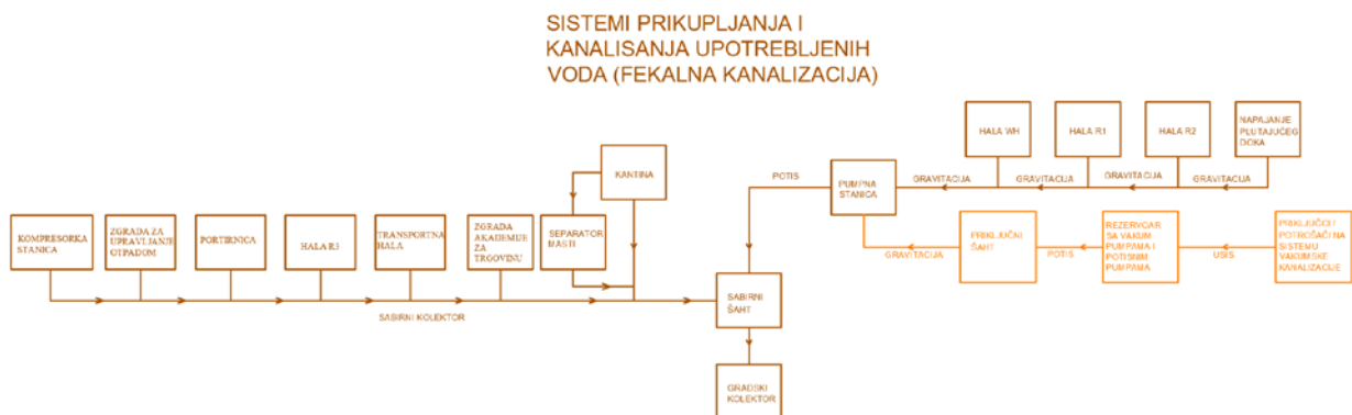
Slika 3.1.2. Sistemi prikupljanja i kanaliziranja upotrebljenih voda – fekalna kanalizacija (H2)
