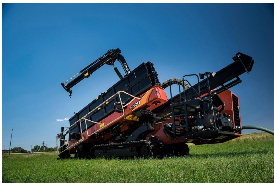
**Slika 38.** Izgled specijalne mašine namijenjene za usmjereni bušenje
