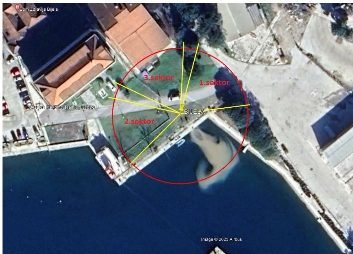
Slika 7.4. Horizontalna komponenta zone nedozvoljenog zračenja
